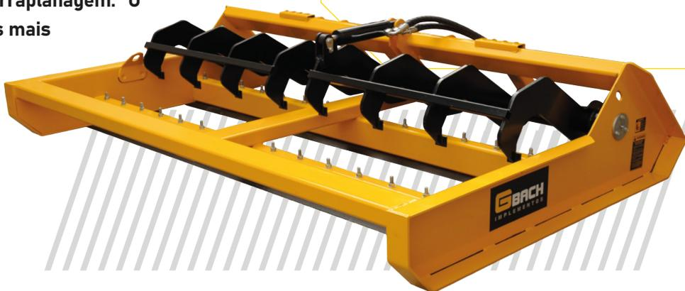
Este implemento também possui como opcional o escarificador, um acessório ideal para preparar e lavrar a terra. Ele possui dentes que rasgam a terra soltando até materiais mais resistentes, sendo que o mesmo é acionado por um pistão hidráulico, não necessitando o operador sair da máquina. De construção simples e robusta, tem um excelente fator custo/benefício.
