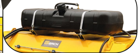
Reservatório do Espargidor
