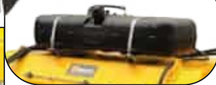
Reservatório do Espargidor
